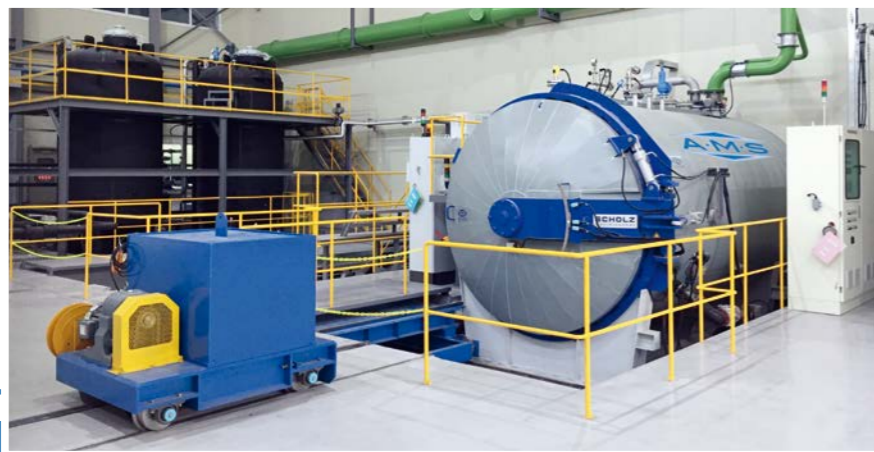
Horizontal VPI with space saving liftdoor cover system Horizontale VPI mit platzsparendem Guillotinen-Deckel
